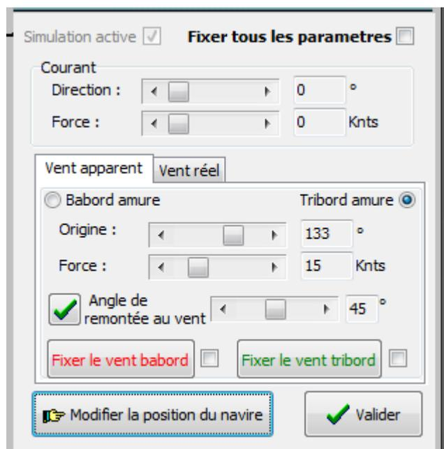
La direction du vent sera alors calculée en fonction de la capacité de remontée au vent de votre navire indiquée par les polaires.
